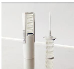
Es una jeringa de vacunación plegable y precargada, fabricada de un solo material: silicona curable por calor. Mediante un proceso que involucra diversos grados de curación, evita la separación completa de varios materiales, lo que ayuda a reducir espacio, energía y facilita su incineración, optimizando con ello los procesos de disposición de desechos.
